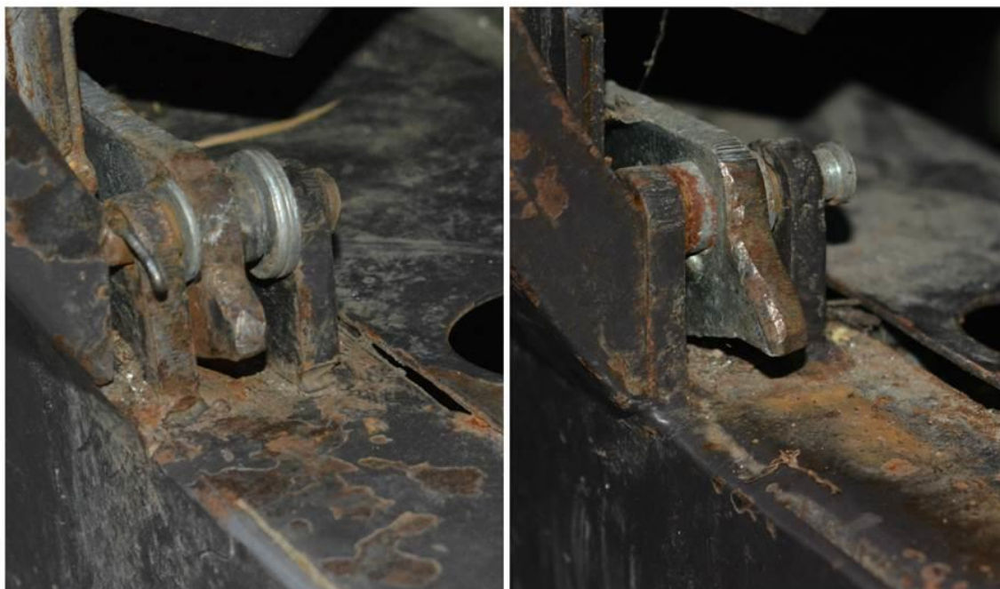
A két felvételen jól látszik a lereszelt és az ép zárószerszék közötti különbség
